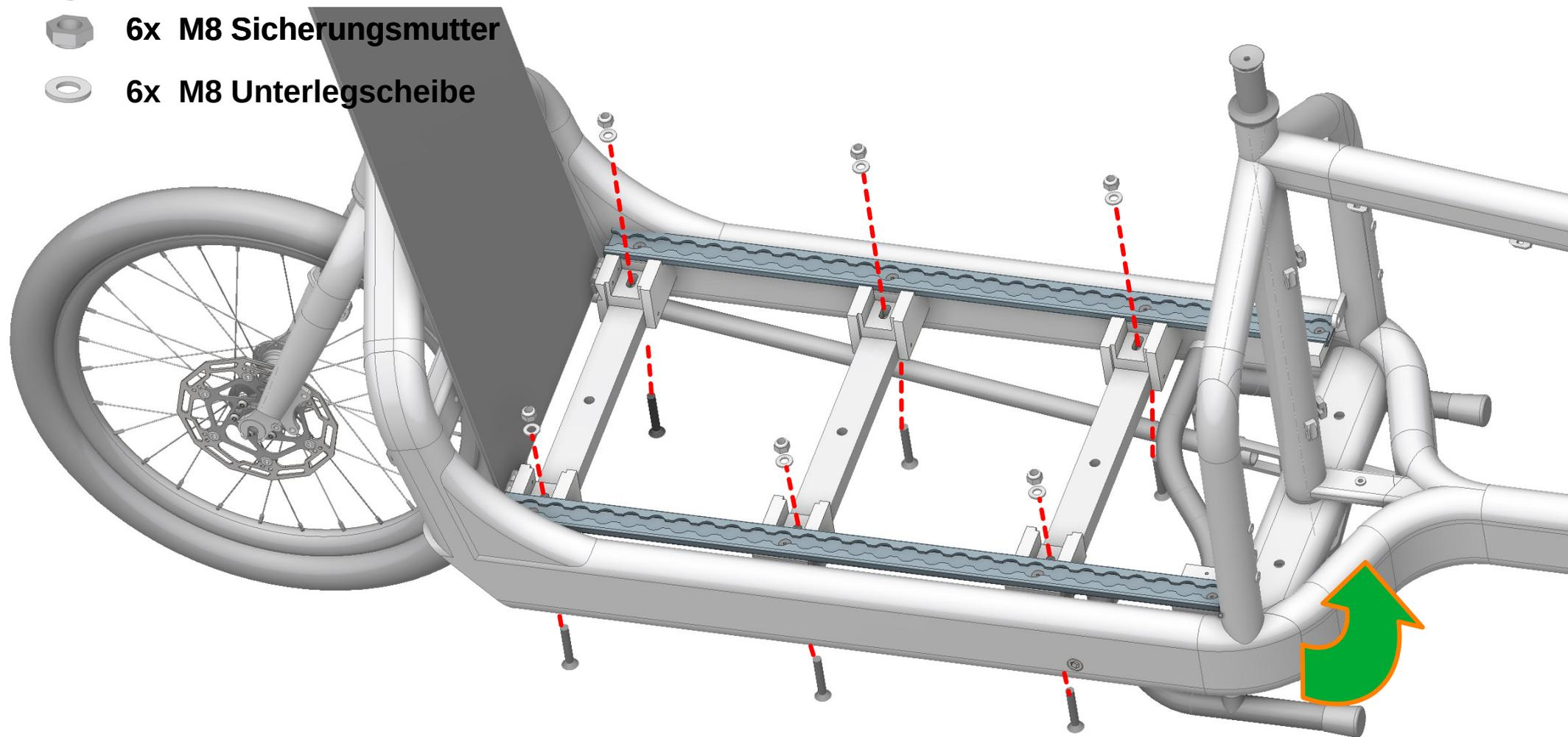
Für die Schrauben unter dem Ständer muss dieser hochgeklappt werden.
