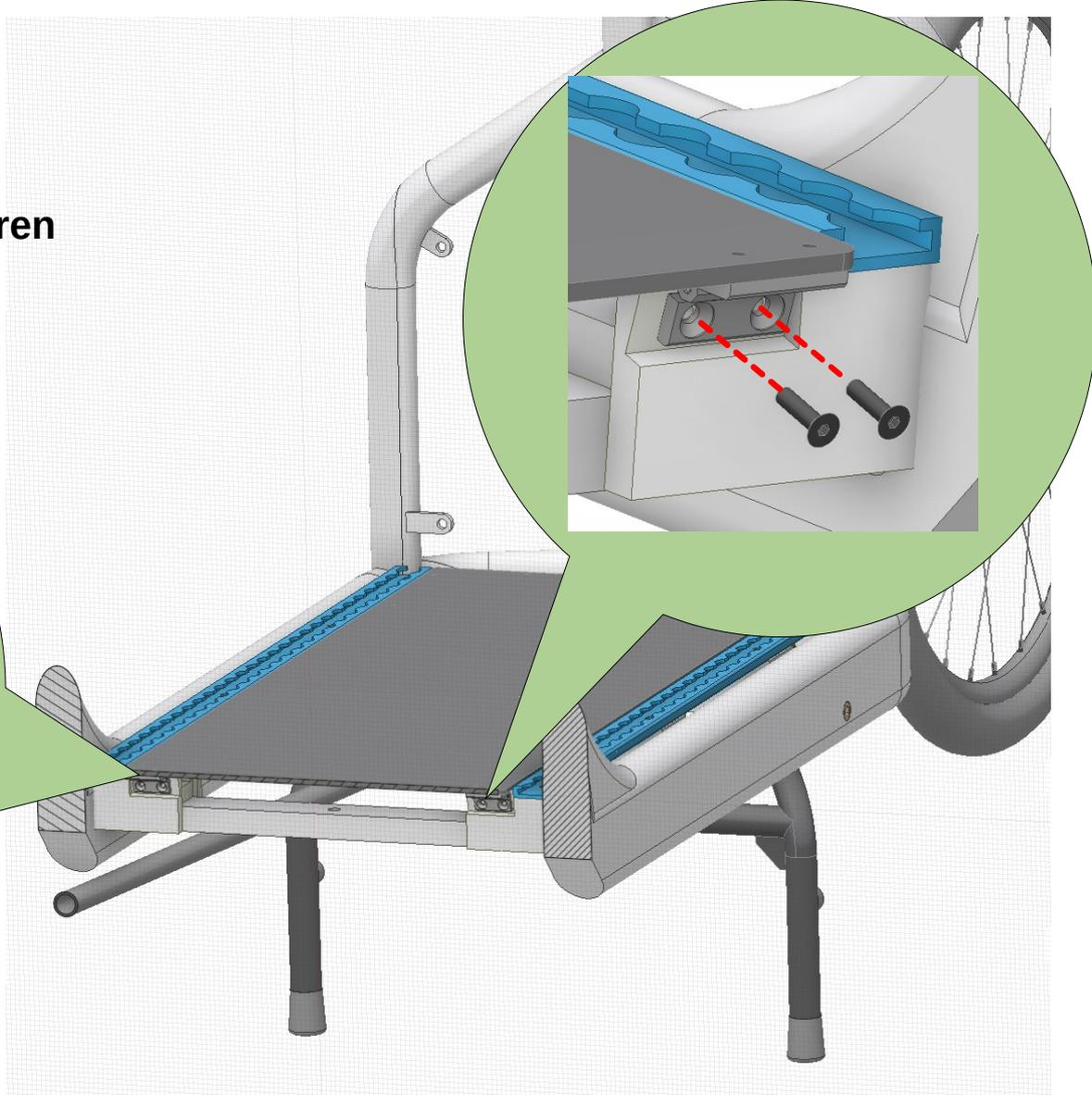
**Airlineschienen am Lenkerende ausrichten.
